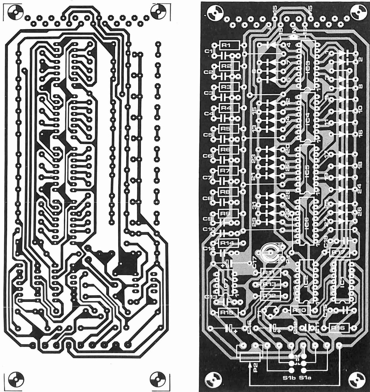
Figura 7. La basetta del generatore di rumore: le sue dimensioni sono le stesse delle altre basette del vocoder, come pure di quelle di figura 4 e 5.
