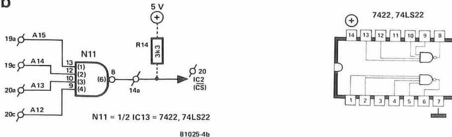
Figura 4. Un circuito alternativo a quello di figura 2 (con due possibilità di inserimento di componenti) che fornisce ulteriori possibilità per quanto riguarda la disponibilità massima di memoria esterna. Solo il blocco di indirizzi della EPROM che comprende la pagina FF non deve essere usato per evitare un doppio indirizzamento.
