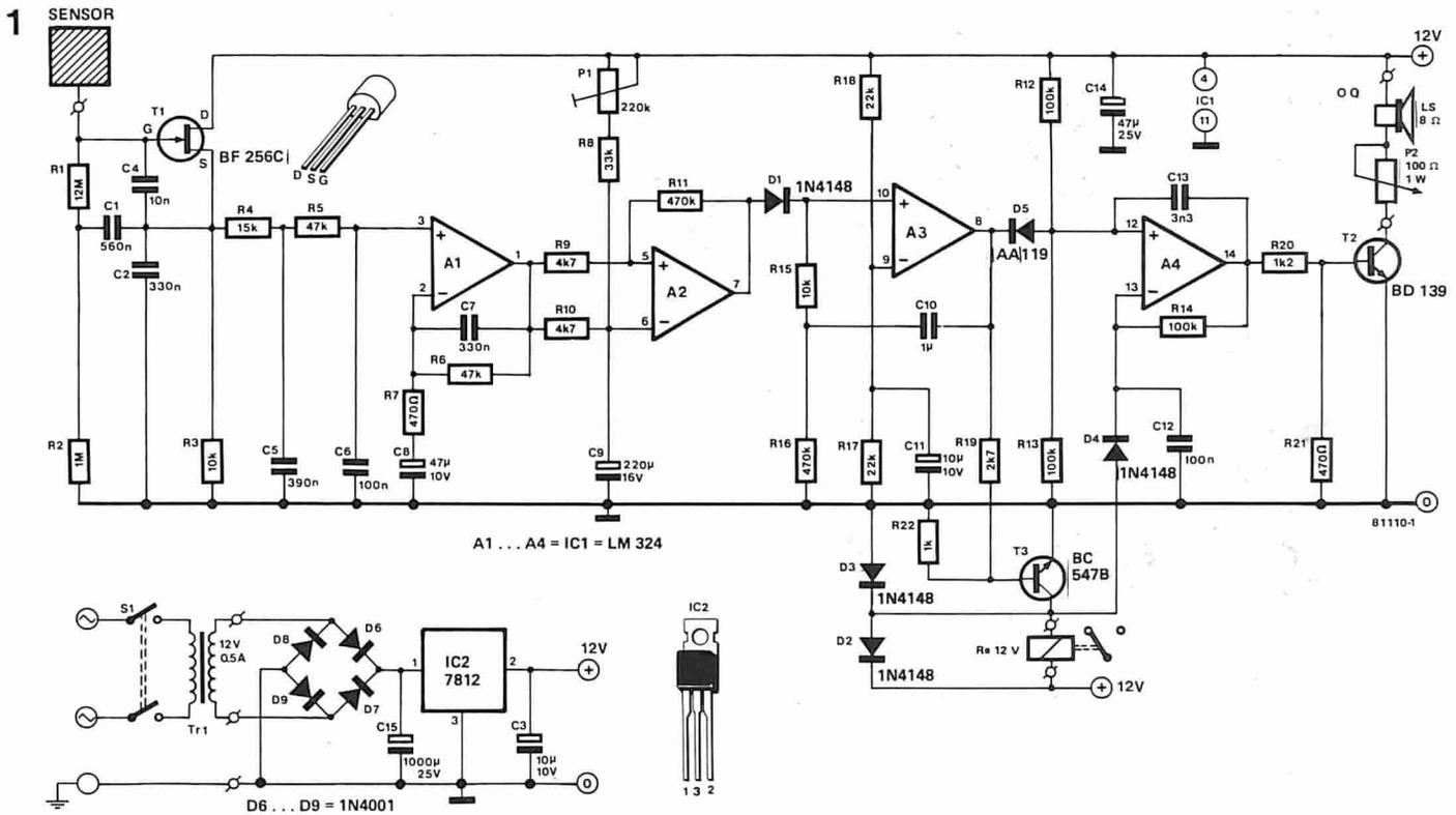
Figura 1. Lo schema elettrico di base del rivelatore di movimenti. Per quanto riguarda il sensore, la più semplice soluzione è quella di usare un pezzo di lastra ramata dalle dimensioni di 15 x 15 centimetri.
