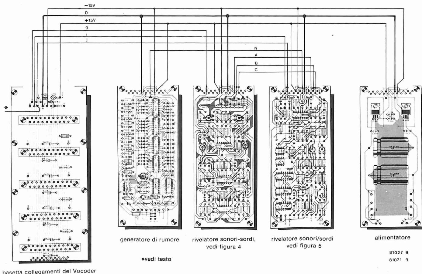
**Figura 9.** Le basette di espansione possono essere anche collegate facendo a meno della mezza basetta di connessione supplementare, però in questo caso il cablaggio sarà un pò più complesso. Anche adesso il ponticello i-j esistente sulla basetta di collegamento di sinistra deve essere interrotto.
