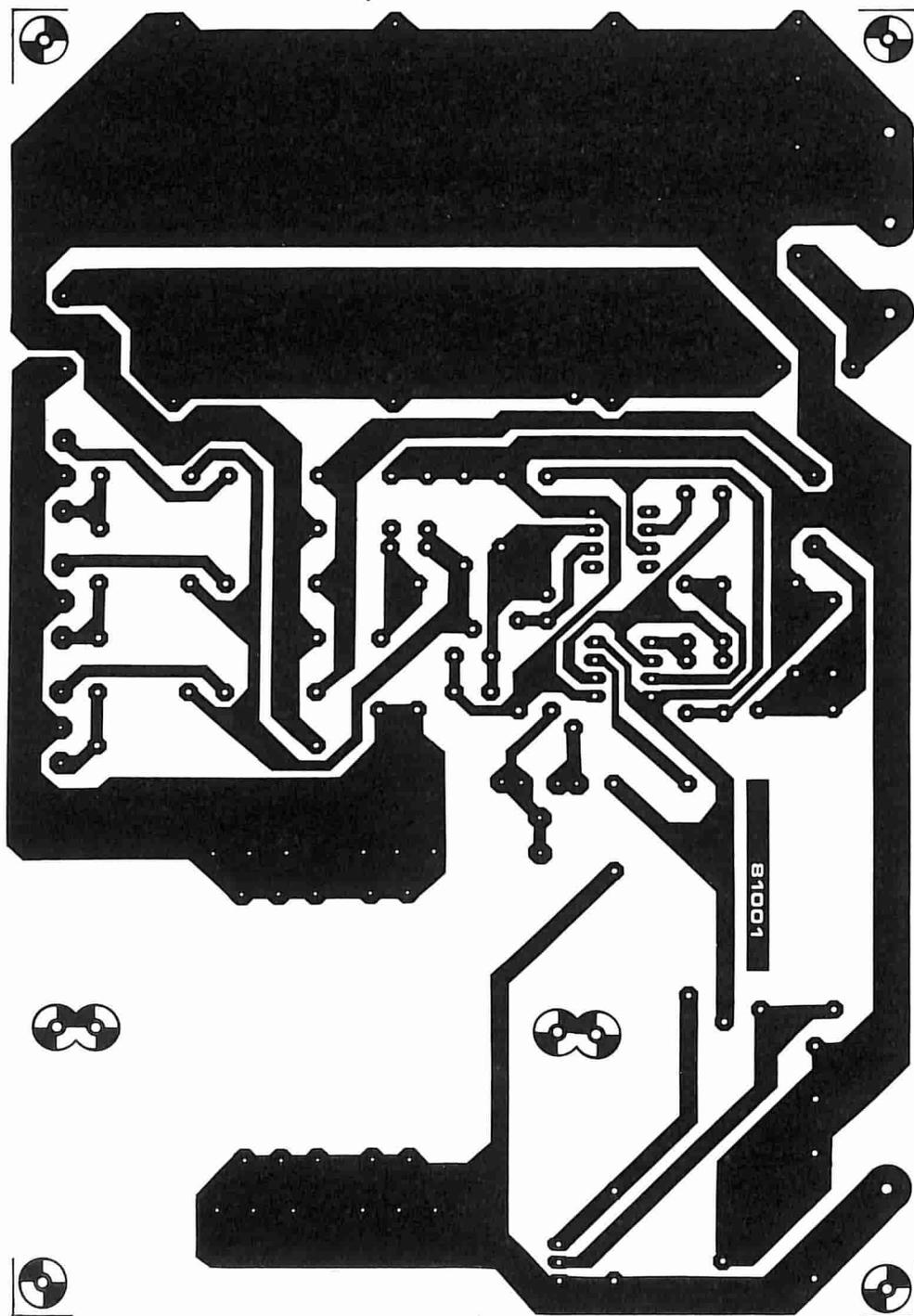
Figura 5. La bassetta stampata e la disposizione dei componenti per il convertitore c.c. - c.c.. Tutti i componenti, compreso il dissipatore termico dei transistori di potenza, possono essere montati su questa bassetta. Il circuito stampato completo di componenti deve essere disposto in un mobiletto metallico per ridurre l'irradiazione di interferenze.
