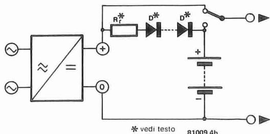
Figura 4. Questi circuiti possono essere usati per aumentare la vita utile delle batterie degli apparecchi portatili, basta che essi abbiano un alimentatore di rete incorporato. La commutazione tra la rete e la batteria (a) può essere automatica utilizzando il commutatore incorporato nel collegamento alla rete.
