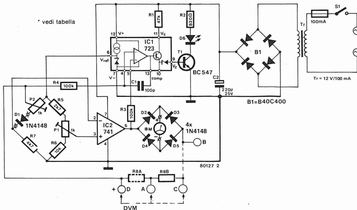
Figura 2. Lo schema elettrico del termometro lineare. Usando come sensore un diodo 1N4148, si può visualizzare la temperatura mediante uno strumento a bobina mobile oppure un voltmetro digitale con ingressi "fluttuanti".
