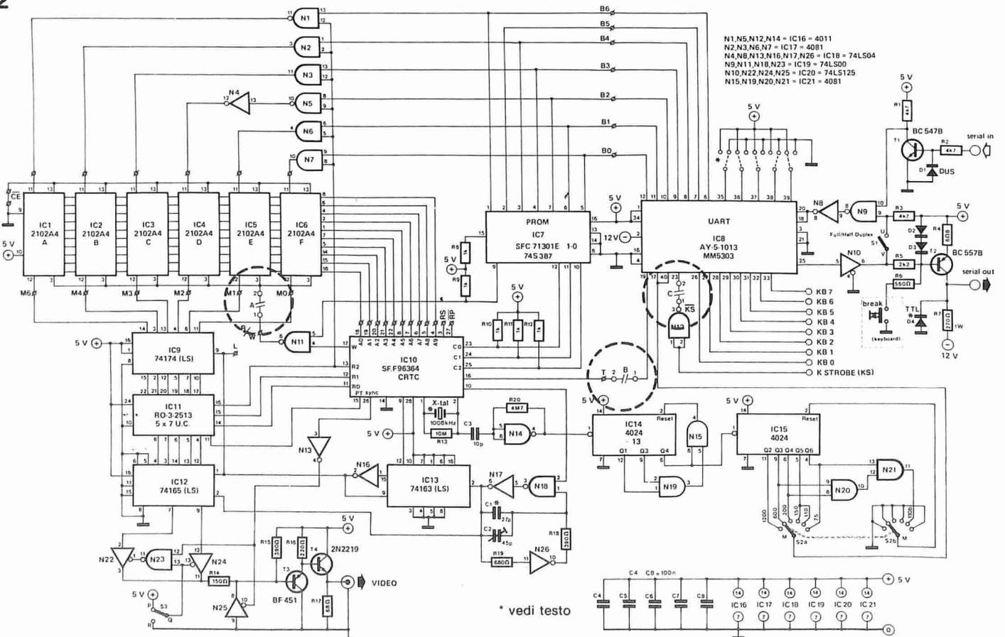
Figura 2. Lo schema originale; nel quale sono chiaramente marcati i diversi punti di connessione. I punti nei quali devono essere interrotte le tracce di rame sono circostritti da cerchietti tratteggiati.
