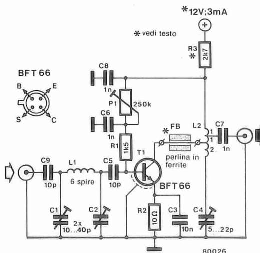
Con questo semplice circuito è possibile ottenere un basso rumore oppure una bassa distorsione di intermodulazione.
