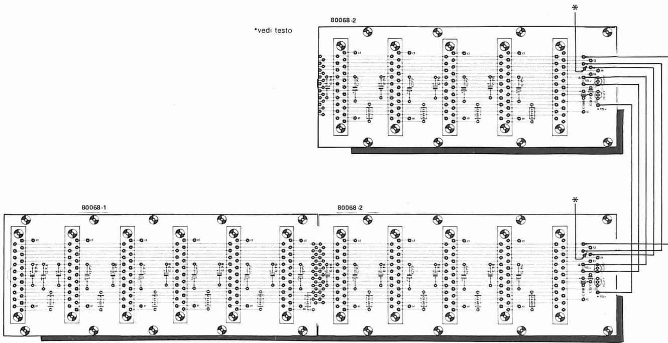
Figura 8. Se si usa una mezza basetta dei collegamenti supplementare, per connettere tra loro le tre basette di espansione, dovrà essere collegata alla basetta dei collegamenti più grande appartenente al vocoder. Le piste di rame tra i punti I-J devono essere interrotte su entrambe le basette.
