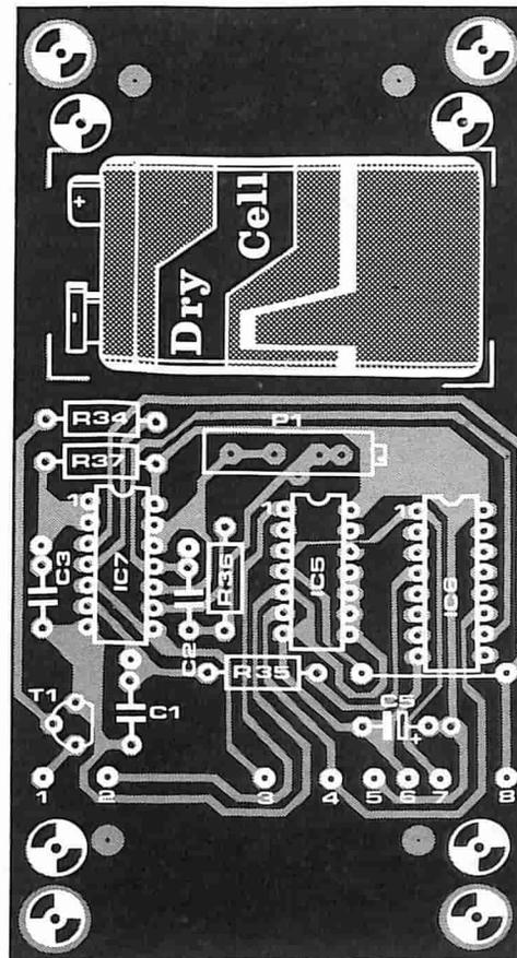
inconveniente, il circuito di sfasamento R35/C1 assicura l'interruzione del transistor T1 quando il livello "1" viene scalato. Le uscite dal registro a scorrimento non saranno sotto carico in questo momento, e tutto il processo si svolgerà come previsto. Quando si voglia interrompere il ciclo, basta commutare S2.
