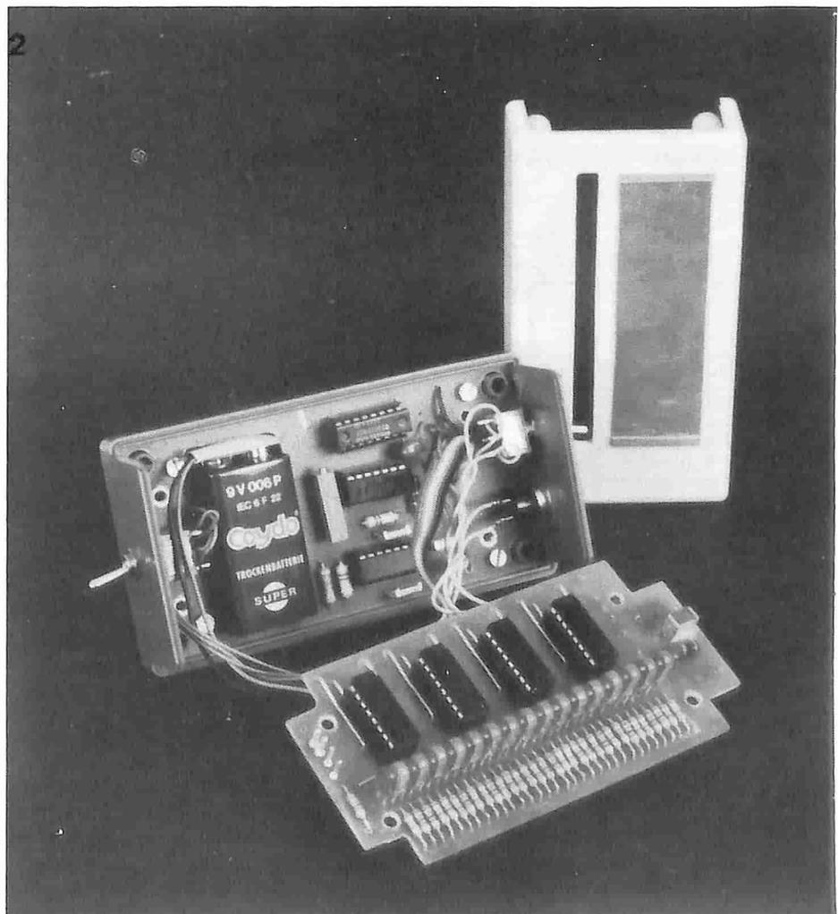
Foto 2. La parte elettronica è suddivisa su due basette stampate, in modo da poter facilmente incorporare il circuito completo in una piccola scatola in plastica.
