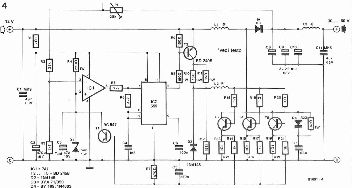
Figura 4. Lo schema completo del convertitore c.c.-c.c.. L'induttanza L1 è avvolta su di un nucleo ad olla provvisto di traferro (per i particolari dell'avvolgimento vedi nel testo). Le Induttanze L2 ed L3 sono dei soppressori d'interferenze rispettivamente da 2 e da 6 A, del tipo usato nei circuiti di controllo a tiristori ed a triac.
