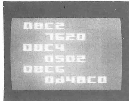
Si deve osservare che questo programma è locato nelle posizioni da 08C0 a 08F6 e da 1F80 ad 1FAD. C'è voluta un pò di abilità ad inserire queste due sezioni separate di programma come unico file nel nastro!
