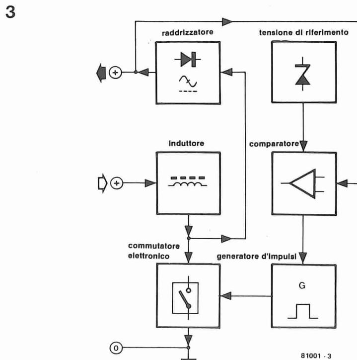
Figura 3. Conversione c.c. - c.c. nella quale la tensione di uscita viene confrontata con una tensione di riferimento per determinare la frequenza di ripetizione degli impulsi del chopper.
