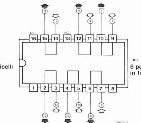
Figura 2. Sulla basetta esiste lo spazio per collegare un buffer (2a) oppure un buffer/invertitore (2b) a ciascuna uscita. Se ciò non è necessario si potranno sostituire IC5 ed IC6 con una serie di ponticelli di filo (2c).
