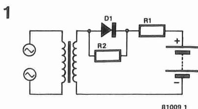
Figura 1. Un circuito di rigenerazione semplice ma efficace.
