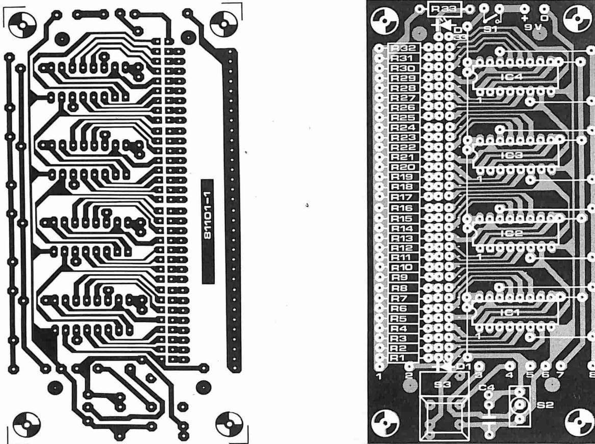
Figura 2. Le due basette stampate e la disposizione dei componenti del temporizzatore di processo.
