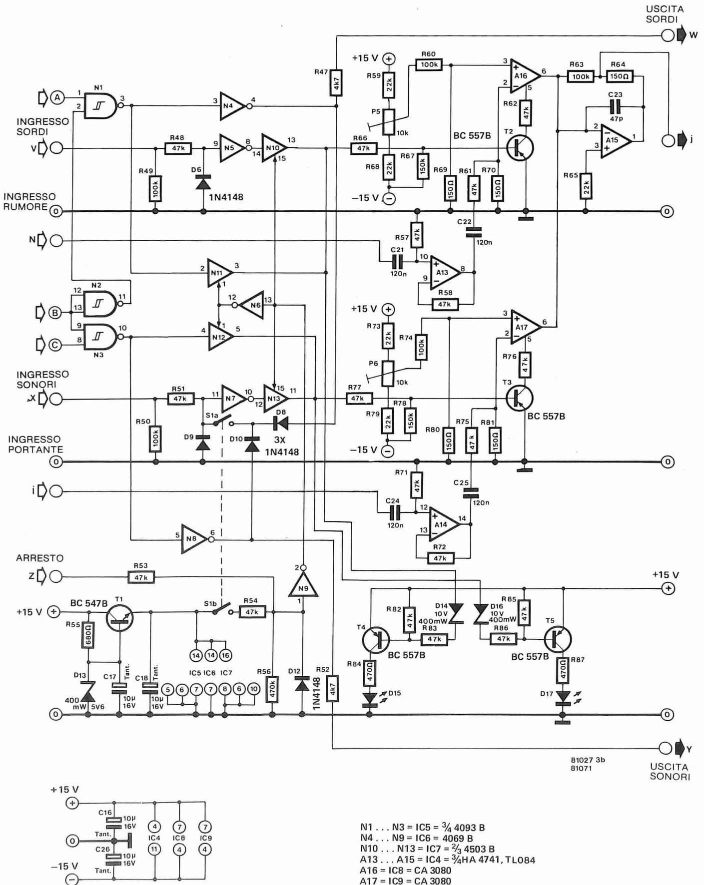
Figura 3. Lo schema completo del rivelatore di suoni sordi/sonori. In linea di massima la Figura 3a forma il sistema di rivelazione e la 3b la basetta di commutazione.
