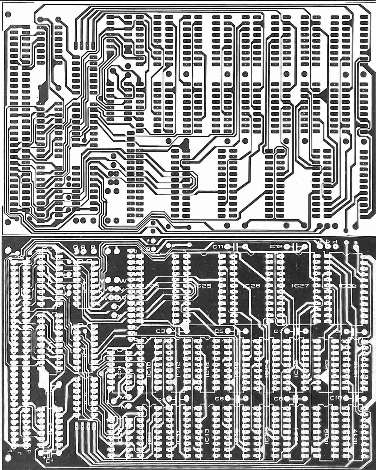
Figura 2. Il circuito stampato e la disposizione dei componenti per la bassetta RAM/EPROM. C'è spazio per 8 K di RAM e per 16 K massimi di EPROM. Il circuito stampato è del tipo a doppia faccia incisa.
