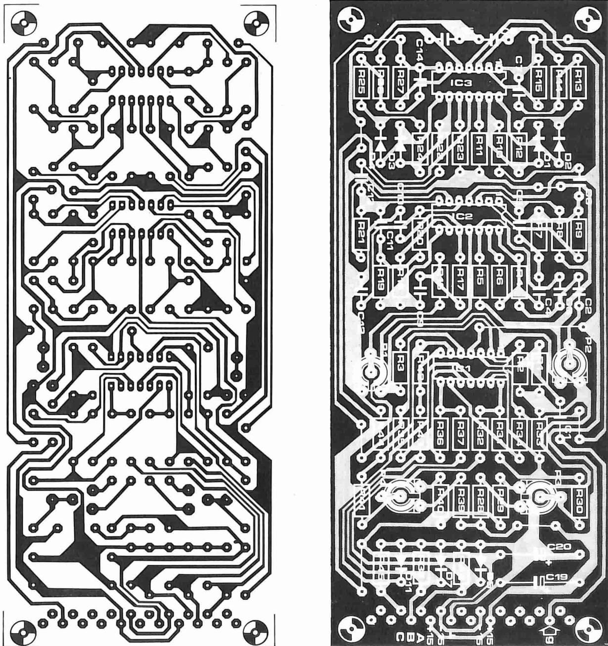
Figura 4. La "basetta del rivelatore". La basetta stampata e la disposizione dei componenti riguardante la sezione di figura 3a.
