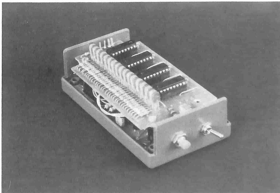
sulla basetta. In questo modo si facilita il rilievo del "salto" della luce.... La basetta è predisposta per accogliere dei LED rettangolari, ma se ne possono usare anche di altre forme, basta che la loro larghezza non superi i 2,54 mm. La scheda di processo è fatta con un rettangolo di cartoncino bianco. Una volta sistemate le divisioni della scala, queste possono essere protette con un nastro "scotch".
