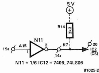
Figura 2. I componenti occorrenti per mantenere i vettori NMI, RES ed IRQ nella pagina 1F. La figura 4 fornisce un'alternativa migliore ma non sempre necessaria.
