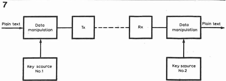
Figura 7. Schema semplificato di un sistema a chiave pubblica, nel quale la chiave e l'algoritmo fondamentale usato dal mittente possono essere divulgati, mentre ognuno mantiene segreta la chiave di decrittazione. Il sistema di manipolazione dei dati da parte del mittente previene la decodifica da parte di chiunque, tranne chi detiene una particolare chiave di decodifica per la quale è stato cifrato il messaggio.
