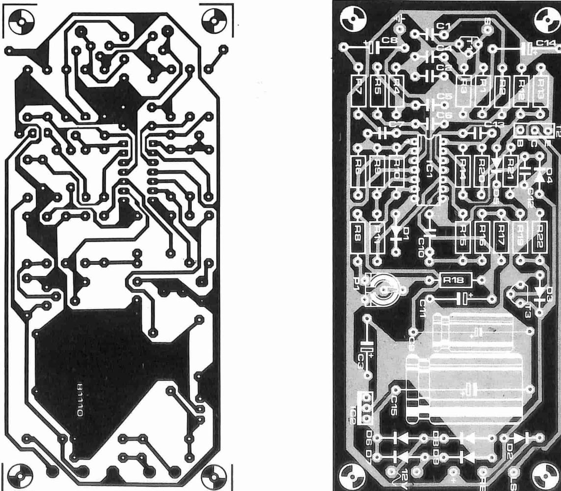
Figura 2. La basetta stampata e la disposizione dei componenti del rivelatore di movimenti. Il trasformatore di alimentazione, il relé, l'altoparlante, nonché il controllo di volume ed il sensore, non sono compresi nel circuito stampato.
