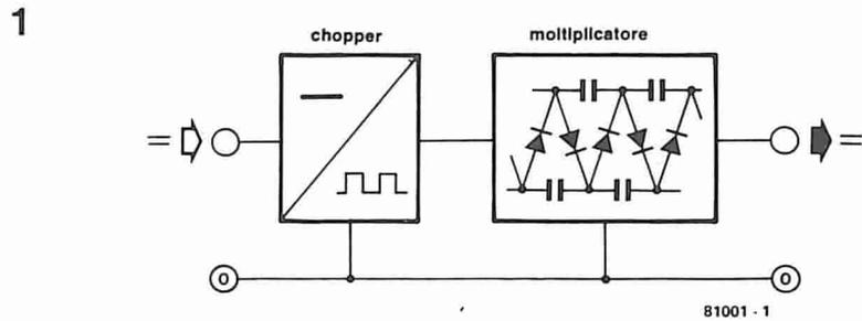
Figura 1. Conversione c.c. - c.c. con modulazione ad impulsi (chopping) della tensione d'ingresso e moltiplicazione del segnale c.a. così ottenuto, mediante una rete di diodi e condensatori.
