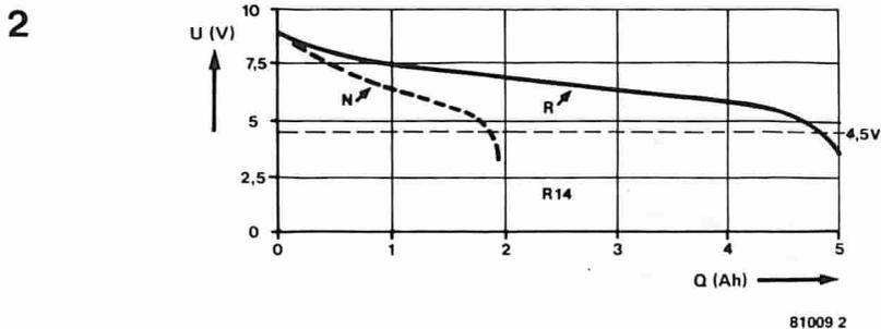
Figura 2. Gli esperimenti dimostrano che la rigenerazione può aumentare le ore di funzionamento di una pila a stilo di un fattore 3.
