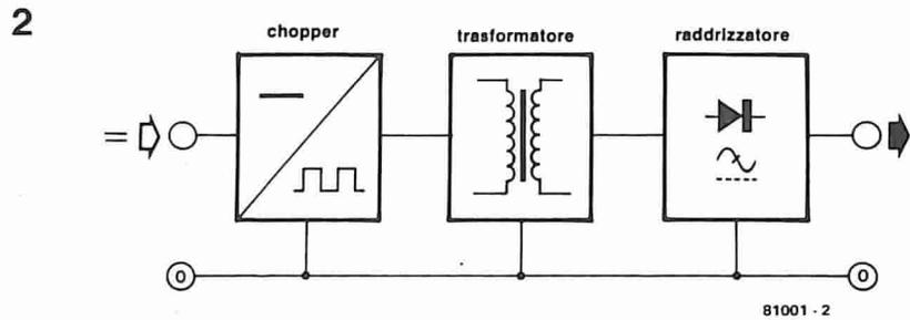
Figura 2. Conversione c.c. - c.c. ottenuta alzando il valore del segnale metallico modulato tramite un trasformatore, prima della rettificazione e del livellamento.
