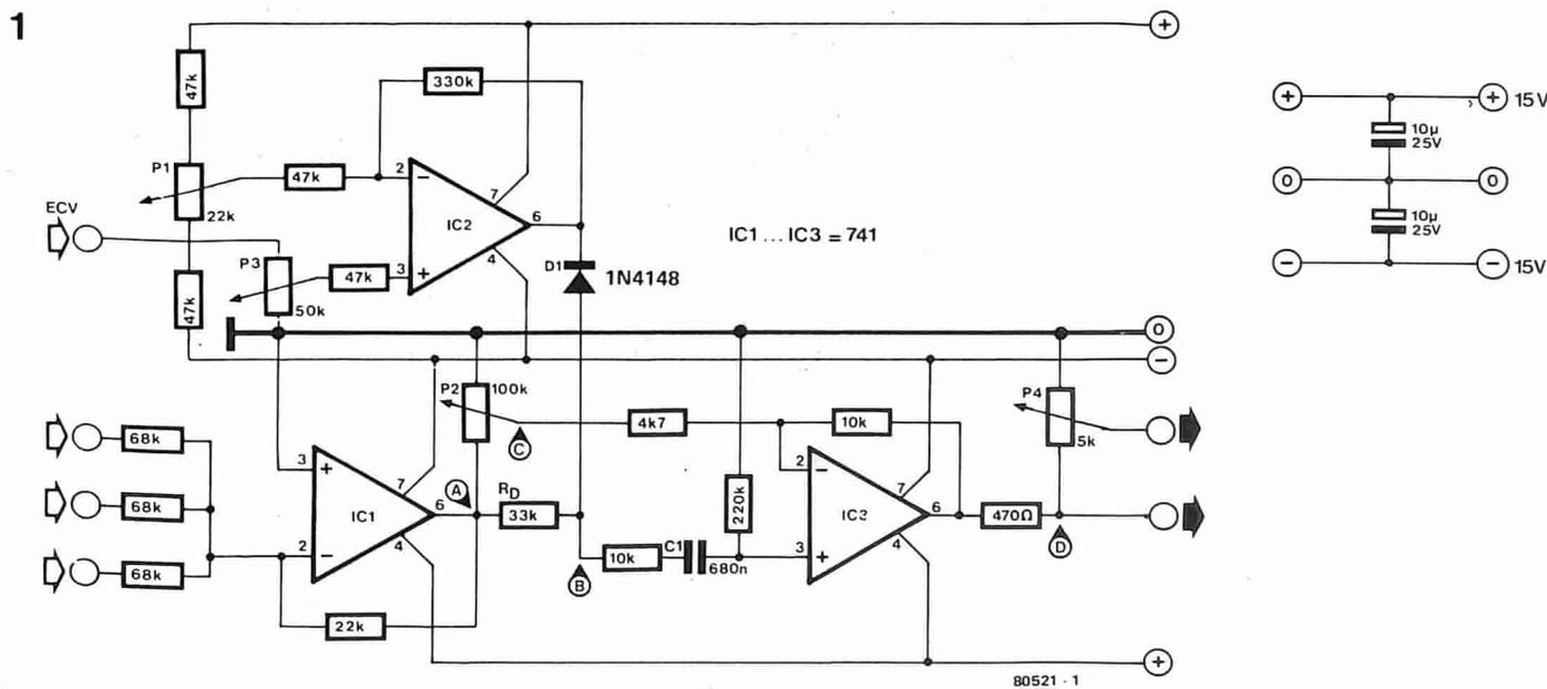
Un generatore di armoniche controllato in tensione è un dispositivo molto pratico da applicare ai sintetizzatori musicali, che si può considerare un altro modo di produrre suoni sintetizzati. Il circuito che presentiamo è stato progettato per essere usato insieme al sintetizzatore musicale Formant di Elektor (che presto pubblicheremo), ma l'idea può essere usata in molte altre applicazioni, come la generazione di armoniche per una chitarra, eccetera.
