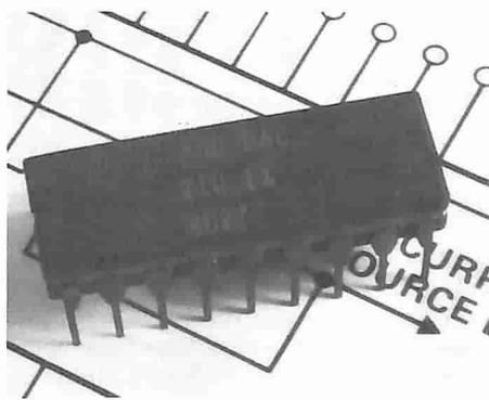
Questo DAC completo contiene nel chip un amplificatore di uscita, un riferimento, uno switch di polarità controllato dalla logica e i ladder network switches.
