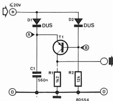
za di tensione tra i punti A e B diventa maggiore di 0,6 V (in altre parole, quando la tensione d'ingresso sarà caduta a 0,6 V), T1 passerà in conduzione facendo scaricare C1 attraverso R1, e generando un impulso all'uscita.
