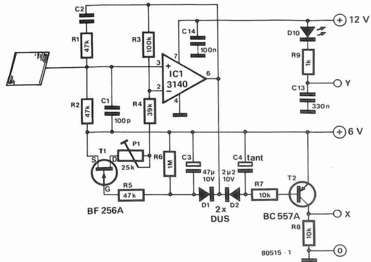
Le perdite capacitive dipendono da parecchi fattori. Umidità e temperatura, ossia in altre parole un cambiamento del tempo, potranno cambiare l'influenza del sensore sull'oscillatore.
