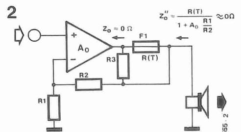
to di controreazione (figura 2) ossia, in altre parole, ripartire la tensione di controreazione, prelevandola da un punto che sta dietro al fusibile. Il fusibile è bypassato dalla resistenza R3, il cui valore è piccolo rispetto ad R2 (piccola influenza sulla regolazione della corrente continua nell'amplificatore), ma grande in confronto all'impedenza di carico di 4 od 8 Ω. Un buon valore per R3 è quello di 220 Ω (1W).
