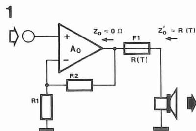
silenzamento dell'amplificatore o per la buona qualità della riproduzione dei toni bassi. Ma c'è ancora dell'altro. Quando una corrente passa attraverso il fusibile, esso si riscalda con un comportamento termico non lineare, e la qualità dei toni bassi mostrerà un coefficiente di temperatura negativo.
