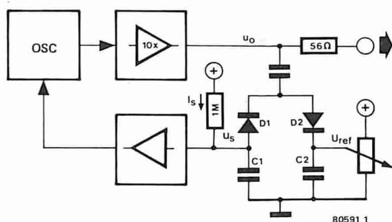
I tipi più semplici di oscillatori ad alta frequenza presentano di solito una degradazione dell'ampiezza della forma d'onda quando la frequenza aumenta. Con questo circuito si è fatto un tentativo di contrastare questi svantaggi e di progettare un oscillatore che avesse un elevato campo di frequenze (100kHz.....100 MHz) e che potesse essere modulato sia in frequenza che in ampiezza, con una forma d'onda più sinusoidale possibile.
