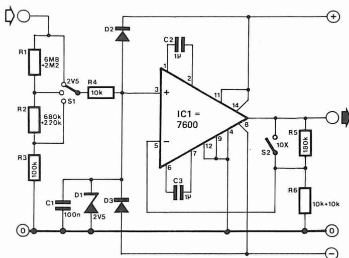
segnale, l'altro viene mantenuto nel modo di autoazzeramento. Ne risulta una tensione di offset a lungo termine di 0,2 µV per anno ed una bassa corrente di polarizzazione di ingresso di soli 300 pA.
