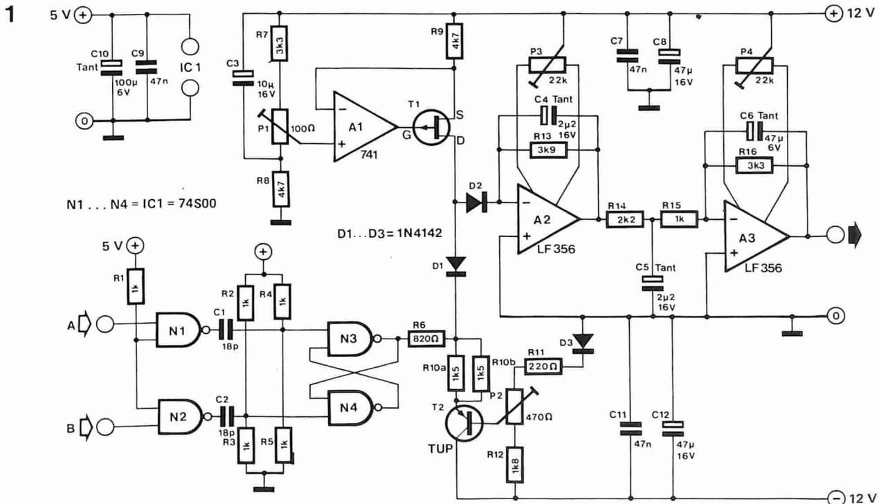
Questo circuito può essere usato per misurare con precisione la fase fino a 1 MHz. Se durante la costruzione si usa tutta la dovuta attenzione, si può ottenere una precisione entro 0,1° fino alla frequenza di 100 kHz. Non male!
