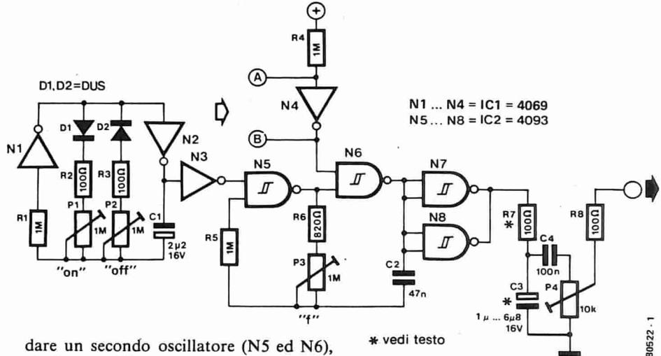
È un dispositivo che serve ad attirare l'attenzione quando non si verifica una certa condizione, e che può avere una vasta gamma di applicazioni. Il circuito che presentiamo è sufficientemente versatile da avvisare e destare l'attenzione ogniqualvolta ciò sia richiesto, oppure per ricordare che una determinata funzione non è avvenuta nel modo giusto.
