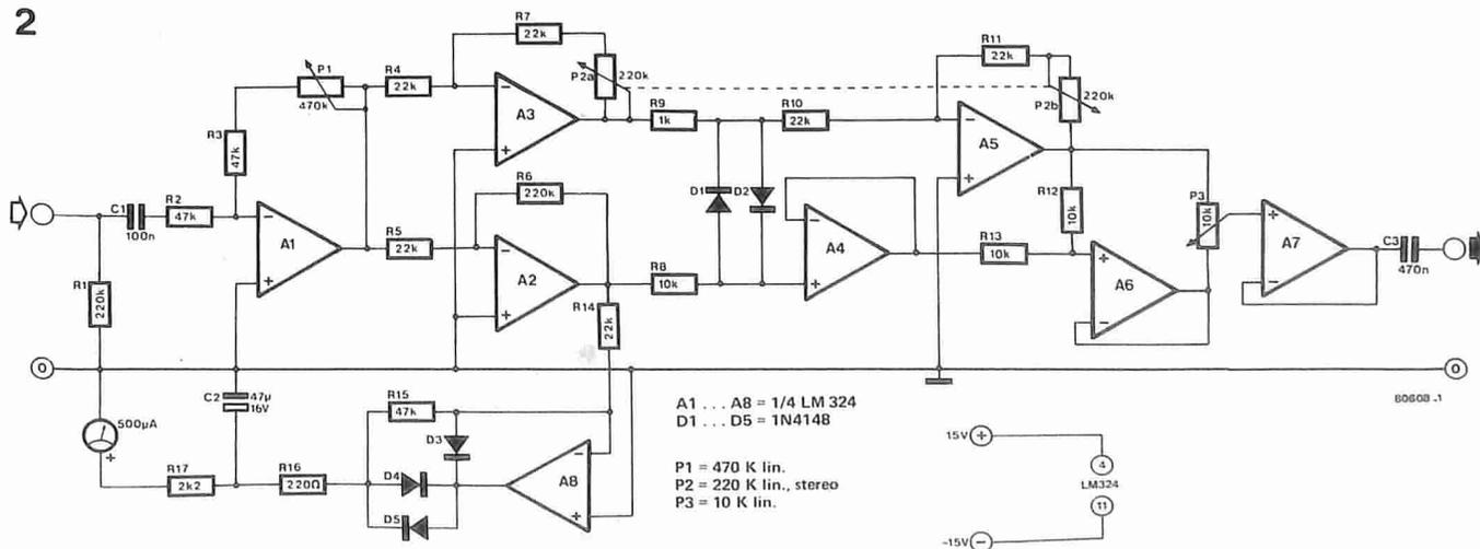
gresso di A4 e l'uscita di A3 viene *esaltata* nei picchi del segnale. Quest'ultimo segnale viene invertito da A5 ed allo stesso tempo il guadagno di questo stadio viene regolato da P2b per compensare la differenza di guadagno nei due percorsi di segnale introdotta in precedenza da P2a. Per ottenere questo risultato P2a e P2b sono collegati per variare "in sensi opposti": quando il valore di uno aumenta il valore dell'altro deve diminuire.
