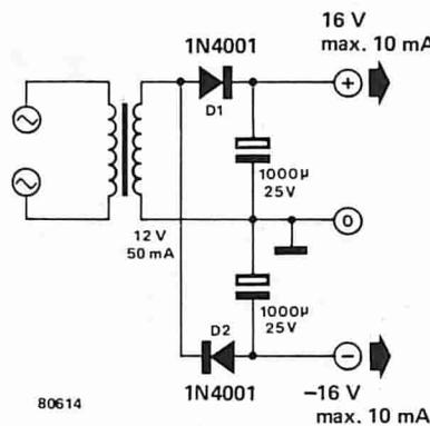
Usando la formula che segue si possono calcolare i valori dei componenti per altre correnti ed altri valori della tensione di ondulazione residua:
