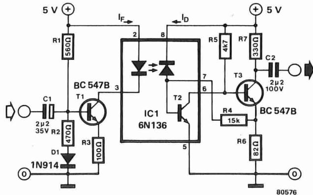
Il transistor di uscita dell'integrato, T2, è collegato in cascata a T3. Attraverso R4 ed R6 avviene la retroazione. R6 è dimensionata per il massimo prodotto guadagno/larghezza di banda di T3. R7 determina l'oscillazione massima di uscita: essa deve essere naturalmente scelta in modo da ottenere la massima uscita senza taglio dei picchi. Il guadagno ad anello chiuso ( $\Delta U_{out}/\Delta U_{in}$ ) viene determinato da R4 secondo la seguente formula:
