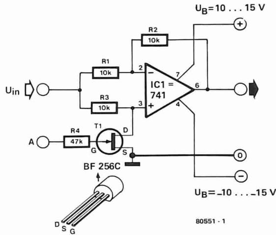
sia al massimo inferiore di 2 V ai valori estremi dell'alimentazione (quindi  $V_b + 2V \leq V_{in} \leq V_b - 2V$ ). L'impedenza della sorgente del segnale deve essere la più piccola possibile, dato che l'impedenza d'ingresso dipende dal fatto
