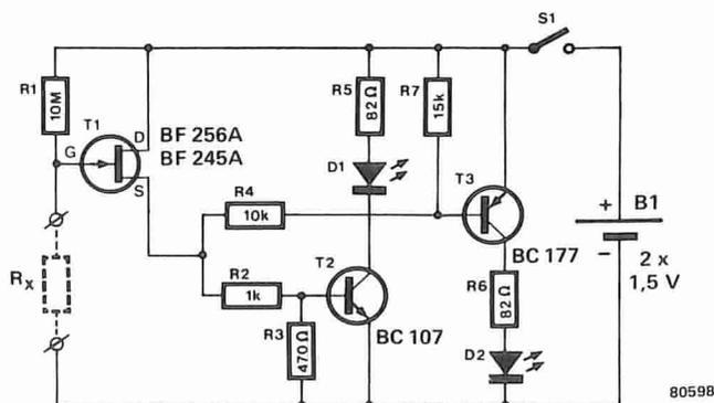
risulterà quindi in conduzione ed il LED D1 sarà acceso. Se la resistenza è inferiore da 5 M $\Omega$  la tensione di gate si abbasserà ed il FET si comporterà come una grande resistenza facendo abbassare in tal modo la tensione di source.
