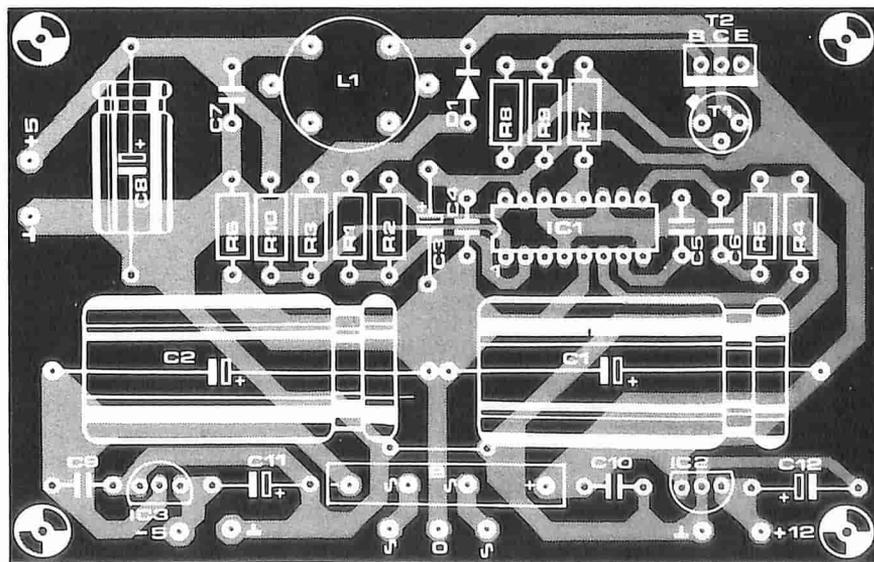
so T2 e D1 durante il funzionamento normale non supera mai i 2 A. La bobina L1 può essere facilmente avvolta su di un nucleo a campana con trafero adatto alla banda di frequenza applicata (20 kHz). È stato usato un tipo N22 della Siemens lungo 11 mm e dal diametro di 18 mm. Il numero di spire può essere calcolato con la seguente formula:
