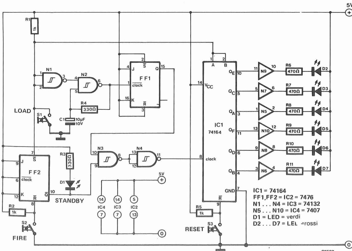
alto, l'uscita di N3 andrà a livello basso ed il registro a scorrimento riceverà un impulso di clock tramite N4. Dato che due degli ingressi seriali di IC1 sono mantenuti in permanenza a livello alto, tutte le uscite del registro a scorrimento andranno a livello alto (e tali resteranno) una dopo l'altra ogni volta che verrà generato un impulso di clock. Il LED corrispondente si spenge-
