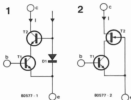
rizzata di figura 1, la base di T2 dovrà essere alimentata con una certa tensione rispetto all'emettitore di T1, almeno -0,6 V (D1 in figura 1).
