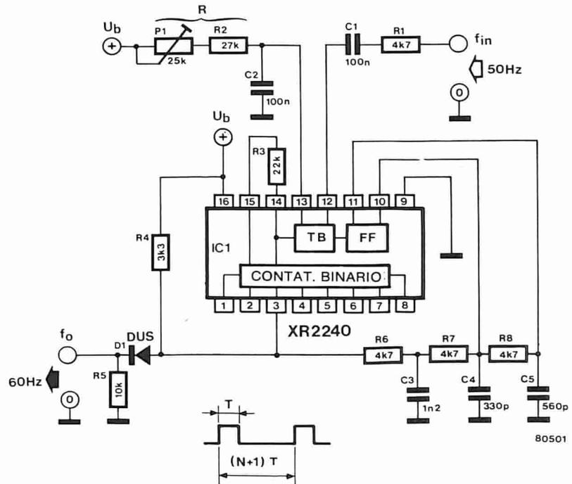
vuole all'uscita è di 60 Hz per una frequenza d'ingresso di 50 Hz. Quindi la frequenza del generatore della base dei tempi deve essere sistemata alla sesta armonica di 50 Hz, ossia a 300 Hz ( $m=6$ ). Questo si ottiene mediante il potenziometro. Se è collegata all'uscita dal piedino 3 (4T), il risultato è  $N = 4$ . Il circuito funzionerà in maniera soddisfa-
