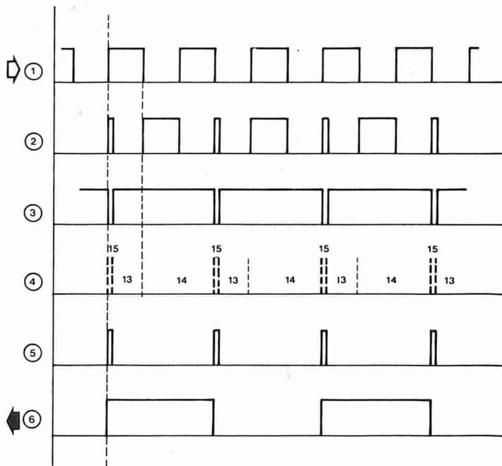
figura 2. Il segnale di ingresso è mostrato sulla riga iniziale (1). Il segnale di clock per il contatore (2) viene derivato da questo invertendolo durante il semiperiodo positivo del segnale di uscita (6) e lasciandolo inalterato quando il segnale di uscita è zero. Questo segnale di "clock" viene contato da IC2.
