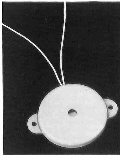
zo; Dato che il segnale base è un'onda quadra, la bobina aiuta ad aumentare il livello di picco, assicurando un'uscita acustica molto efficace.
