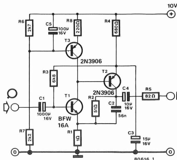
do C2. La corrente che passa attraverso lo stadio di uscita (T2) è prestabilita sui 10 mA, cosicché potranno essere manipolati i livelli di uscita fino a 200 mV con un minimo di distorsione.
