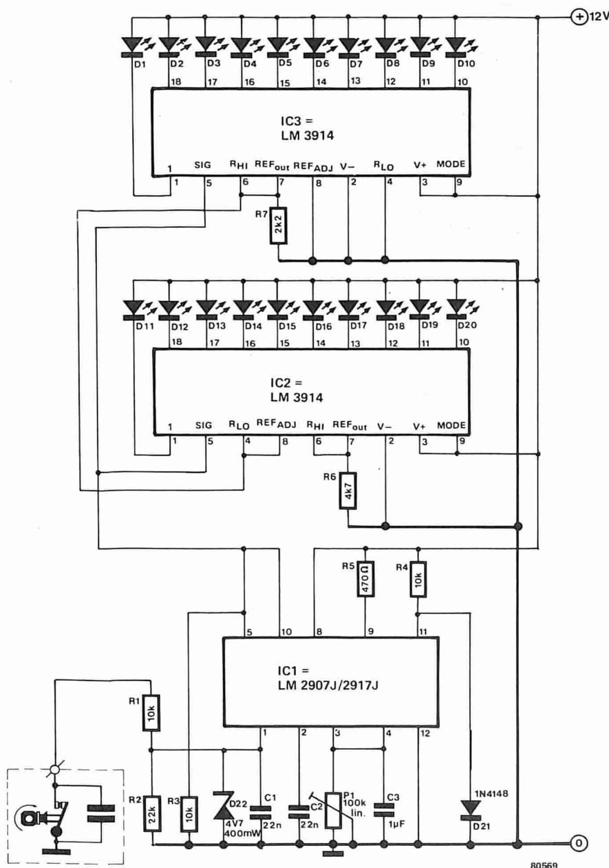
legati in cascata, in modo che i 10 LED controllati da ciascuno di essi formino una unica riga. In questo caso i LED di IC3 saranno i primi 10 della riga. Il collegamento a cascata avviene tra il piedino 6 di IC3 ed il piedino 4 di IC2. Una tensione di ingresso di 1,2 V accenderà in successione tutti i LED di IC3 ed un valore superiore a questo livello azionerà IC2.
