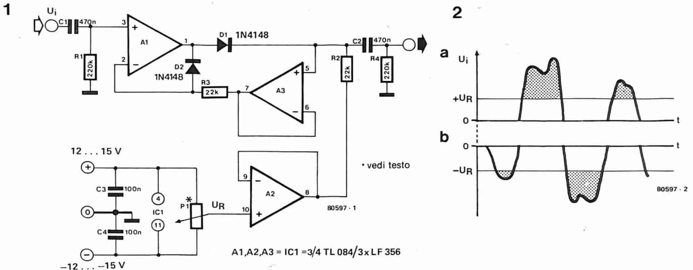
riata mediante il potenziometro P1. Il circuito funziona con sufficiente precisione per frequenze che arrivano ai 20 Hz. Quali sono le utilizzazioni di questo apparecchio? Ci si può fare una lente l'ingrandimento elettronica. Supponiamo di dover esaminare nei particolari su di un oscilloscopio solo una piccola porzione di un segnale in corrente alternata. L'aumento del guadagno dell'oscilloscopio può produrre la zona amplificata necessaria ma, a parte un sovrappilottaggio imprevedibile, il
