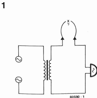
Ci sono molte situazioni nella quali è necessario provare la continuità elettrica dei collegamenti ai connettori e le varie interconnessioni che si possono avere su un circuito stampato. Queste prove possono essere eseguite mediante un ohmmetro, ma spesso è impossibile tener d'occhio contemporaneamente il quadrante dello strumento ed i puntali, che potrebbero sempre andare a mettere in cortocircuito qualcosa.
