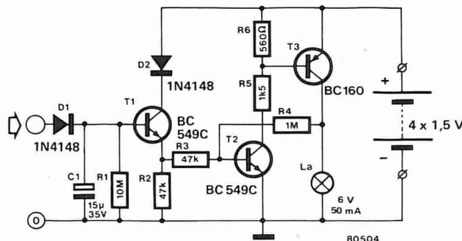
All'ingresso del circuito si collega il filo proveniente dalla dinamo che normalmente va al fanalino posteriore. In presenza di una tensione, T1 è mandato in conduzione e fornisce corrente alla base di T2 e di T3. La lampadina quindi si accenderà. Quando il ciclista si arresta e la dinamo cessa di erogare tensione, T1 continua a condurre per alcuni minuti, finché il condensatore C1 si è scaricato su R1 di una quantità tale da provocare il basculamento del trigger di
