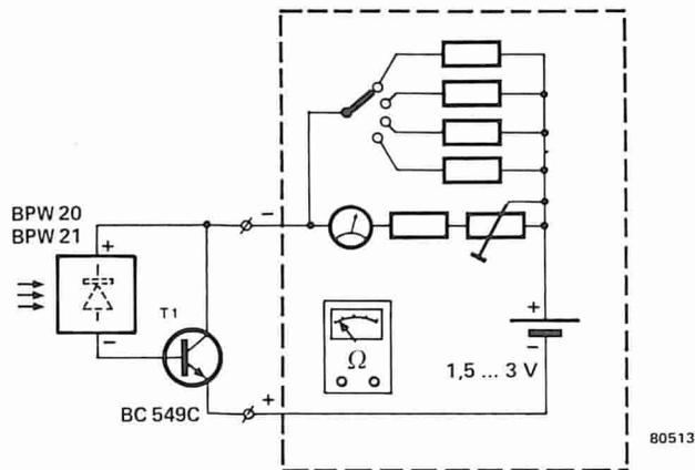
Il circuito funziona come segue: il diodo di prova è collegato tra il collettore e la base del transistor. Tanto maggiore sarà la luce incidente sul diodo tanto minore sarà la sua resistenza e quindi esso fornirà alla
