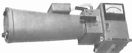
quantitativa perchè mediante un'adeguata calibrazione, è possibile misurare la concentrazione del composto in esame.
