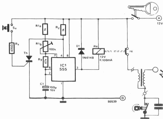
livello basso l'ingresso di reset (piedino 4). Il relè sarà eccitato ed i suoi contatti resteranno chiusi mantenendo la continuità del circuito di accensione. Non appena il motore viene spento girando la chiavetta d'accensione, il circuito si riattiverà automaticamente.
