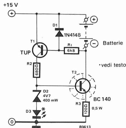
ed R1. La tensione ai capi di una batteria inserita nel modo sbagliato manderà all'interdizione T1 impedendo il funzionamento del caricabatterie. Questo fatto sarà evidenziato dal LED che non si accenderà. Se la batteria è inserita nel modo giusto, T1 passerà in conduzione e l'apparecchio funzionerà nel modo normale.
