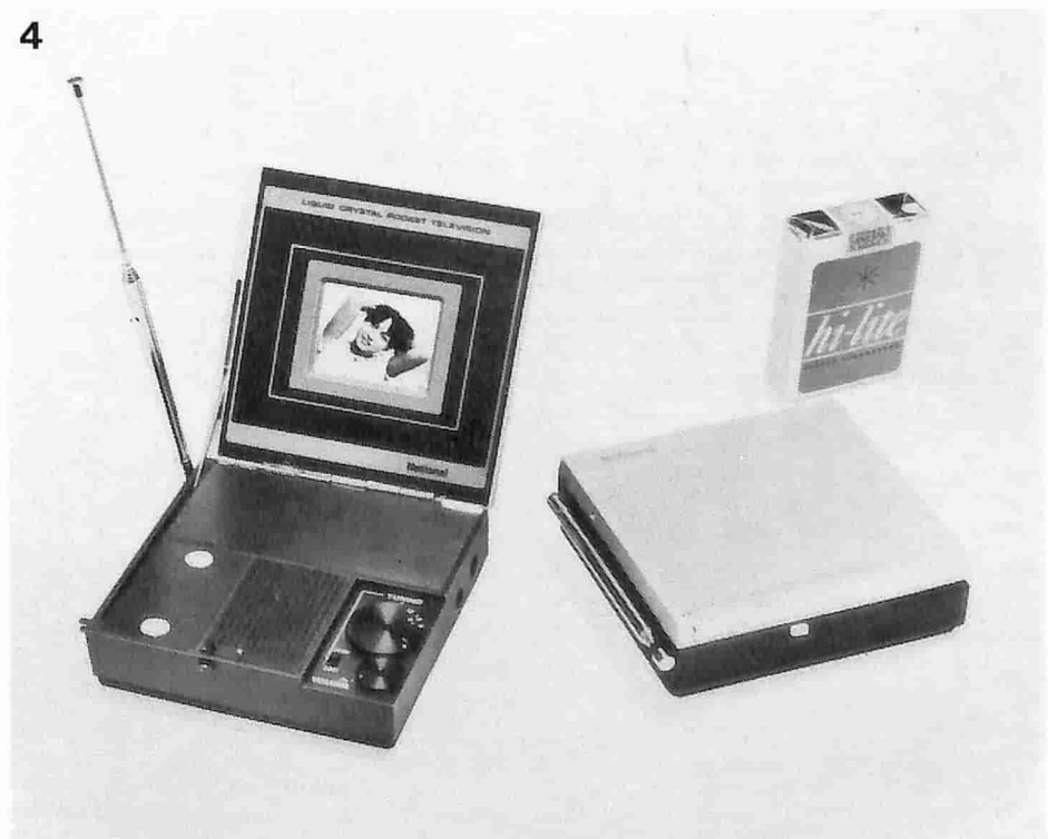
Fotografia 4. Lo schema a cristalli liquidi in un prototipo di televisore tascabile costruito dalla National Panasonic (Matsushita). Con un totale di 57.000 punti di visualizzazione, funziona con un'alimentazione di 4,6 V.
