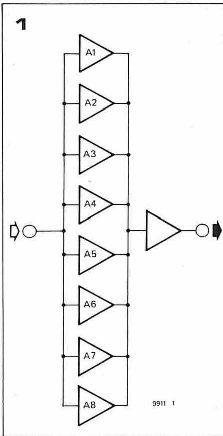
Figura 1. Schema a blocchi che mostra il principio dell'amplificatore a cancellazione del rumore.
