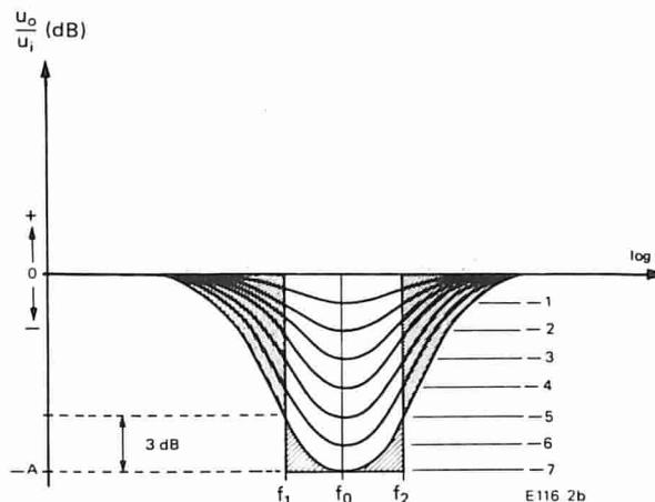
Il concetto che sta alla base della soluzione di compromesso è mostrato in figura 1; questa risposta differisce da quella rappresentata in figura 2 dell'articolo sull'equalizzatore per il fatto che tutte le curve rettangolari di banda passante stanno al di sotto della linea a 0 dB. Il filtro produce quindi solo attenuazione, e questa si riduce a zero al fine corsa superiore del potenzi-
