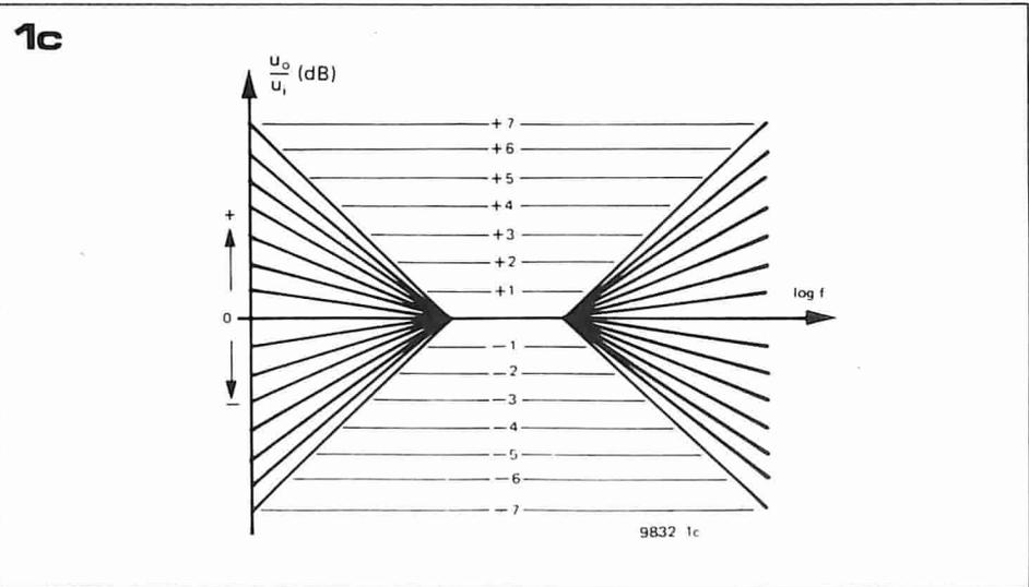
Figura 1b ed 1c. I circuiti di controllo dei toni tipo Baxandall possono avere frequenze di transizione variabili e pendenza fissa, oppure pendenza variabile e frequenza di transizione fissa; in entrambi i casi controllano solo le estremità (alta e bassa) dello spettro audio.
