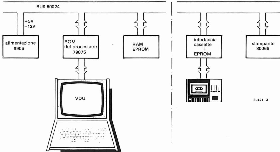
Figura 3. Lo SC/MP è stato equipaggiato con un terminale. Inserendo sulla bassetta del processore una ROM preprogrammata per il BASIC ristretto, la programmazione può essere fatta con questo linguaggio. A destra della linea tratteggiata sono mostrate le possibilità di espansione.
