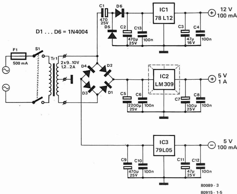
Figura 3. L'alimentatore che produce i tre livelli di tensione che occorrono per il Junior computer.
