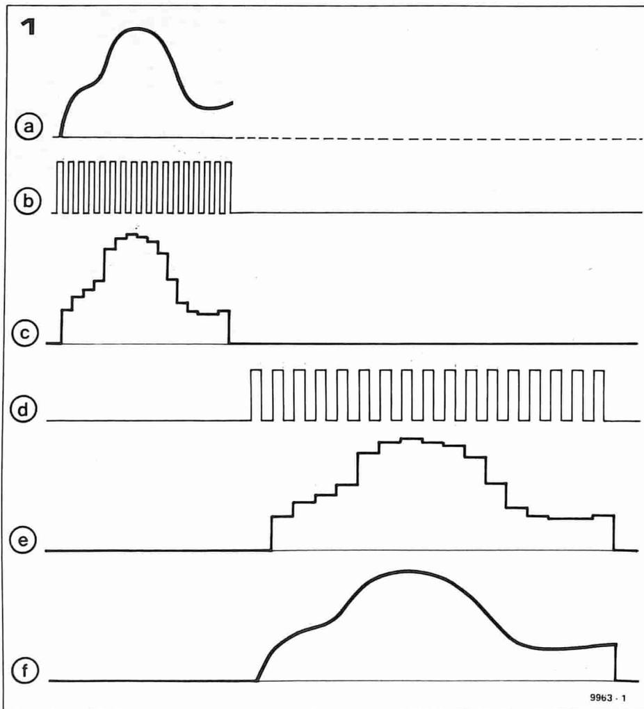
vengono usate alternativamente: mentre una sta memorizzando il segnale d'ingresso, il contenuto dell'altra viene letto e visualizzato sullo schermo. Questa compilazione supplementare è necessaria per non provocare interruzioni della visualizzazione: se si avesse a disposizione una sola memoria, la diversa frequenza di clock durante il periodo di scrittura nella memoria renderebbe inutilizzabile il display in questi intervalli.
