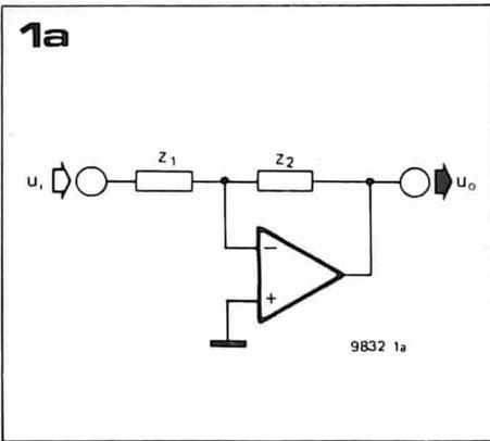
Figura 1a. Il circuito di controllo dei toni tipo Baxandall consiste in un amplificatore con impedenze dipendenti dalla frequenza all'ingresso e nell'anello di retroazione. Se queste impedenze sono bilanciate la risposta in frequenza è piatta, mentre in caso di sbilanciamento ottenuto azionando uno o l'altro potenziometro di controllo di tono, si avrà un'esaltazione od un'attenuazione.
