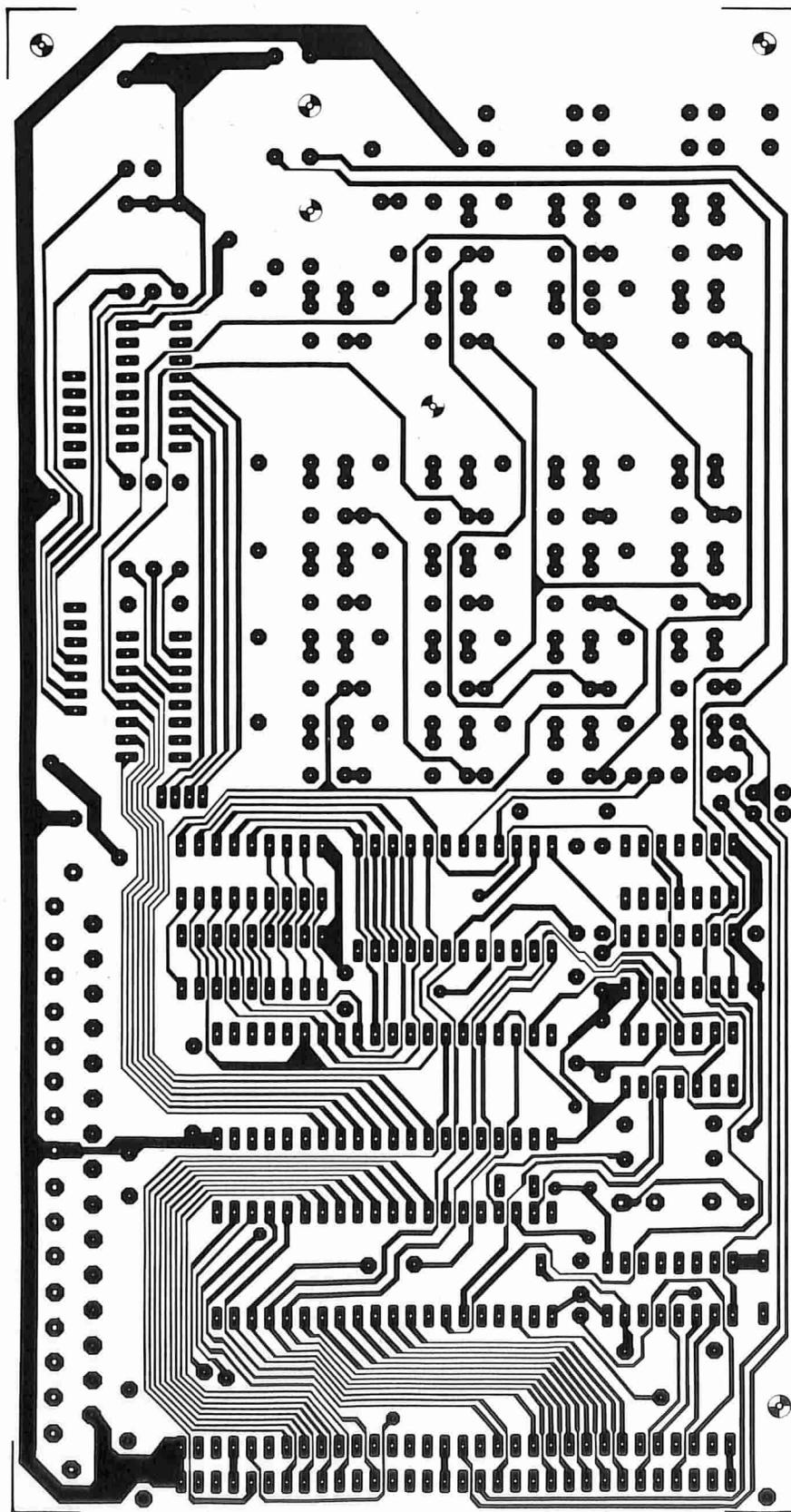
Figura 5. Il percorso delle piste di rame sulle due facce (a e b) della basetta principale.
