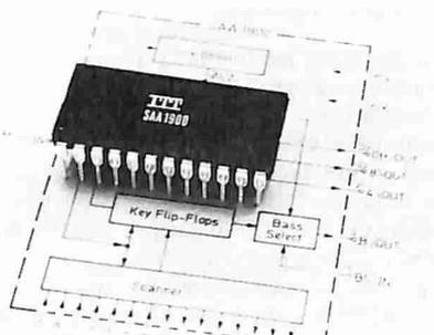
I 56 singoli contatti che vengono esplorati sono divisi in due parti: la tastiera "assolo" (37 tasti) e la tastiera "accompagnamento" (19 tasti). La parte "assolo" della tastiera controlla due uscite voce indipendenti, 4' ed 8'. Le uscite singole per gli ACCORDI e BASSI sono controllate dalla parte "accompagnamento" della tastiera. Tutti i segnali di uscita sono compensati in c.c. per la soppressione dei clicks l'IC SAA 1900 è prodotto in package di plastica a 24 pin.
