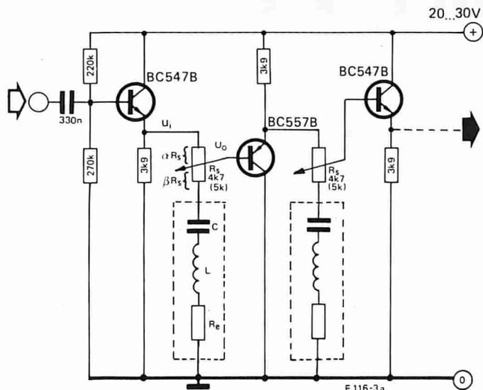
metro appartenente al filtro in esame. Analogamente le curve mostrate in figura 2b corrispondono alla metà inferiore delle curve riportate sulla figura 5 dell'articolo dell'equalizzatore. I filtri che consideriamo ora hanno però una spaziatura tra le frequenze di centro banda di un terzo di ottava, e quindi le frequenze \$f\_1\$ ed \$f\_2\$ sono più vicine al centro banda \$f\$ di quanto non siano nei filtri di ottava.
