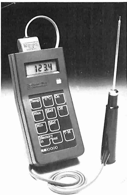
Il termometro è dotato di un visualizzatore a 3 1/2 cifre a cristalli liquidi alti 9mm con retroilluminazione automatica.
