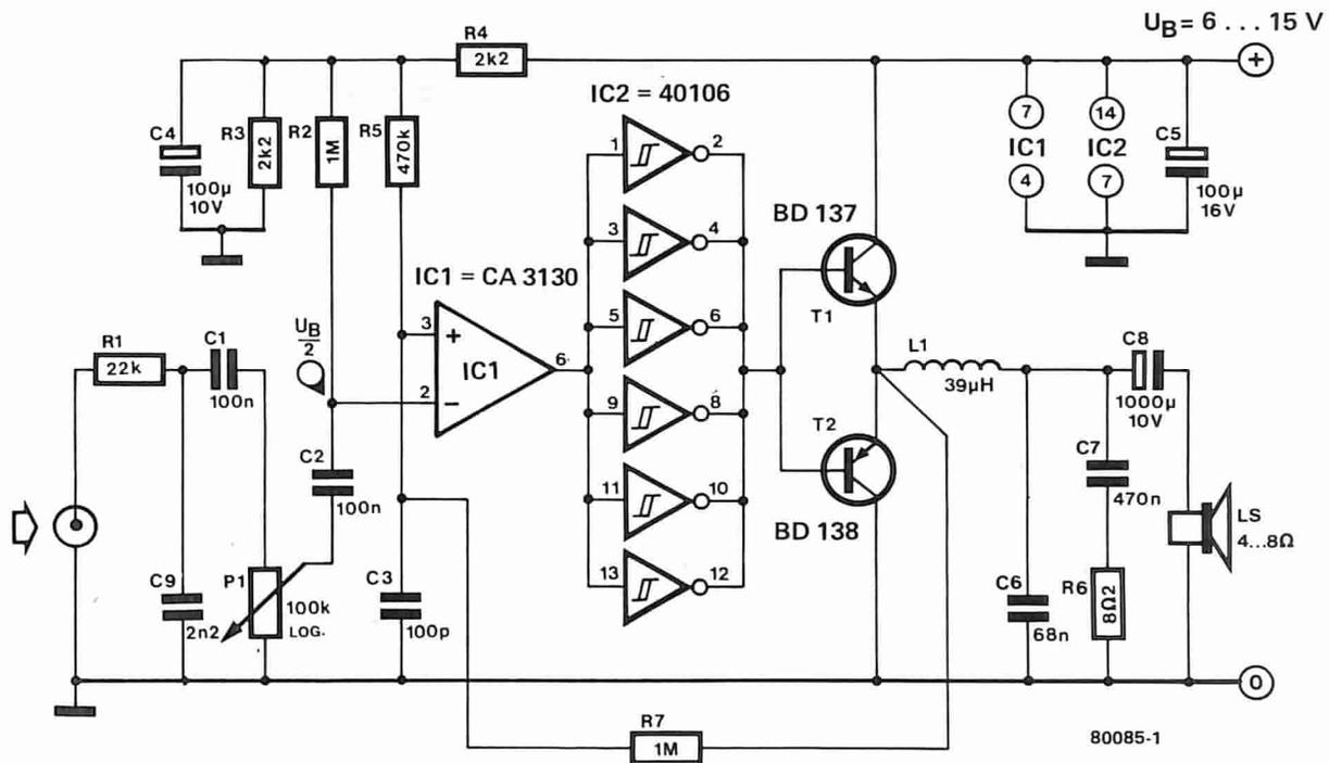
Figura 1. L'amplificatore PWM autoscillante. Con un'alimentazione di 12 V fornisce una potenza di 3 W su 4 Ω.
