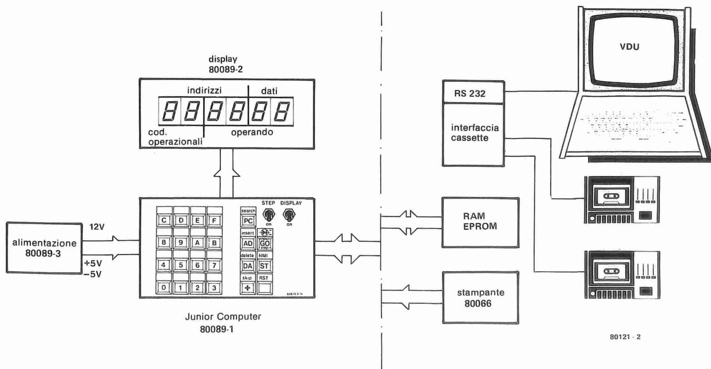
Figura 2. La sezione a destra della linea tratteggiata contiene il Junior computer in versione base. I moduli a destra si possono aggiungere se occorre.
