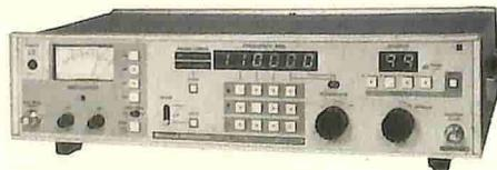
Una tastiera permette di prefissare  $32$  frequenze fisse di uscita e  $4$  livelli di uscita. L'apparecchio può essere comandato a distanza.
