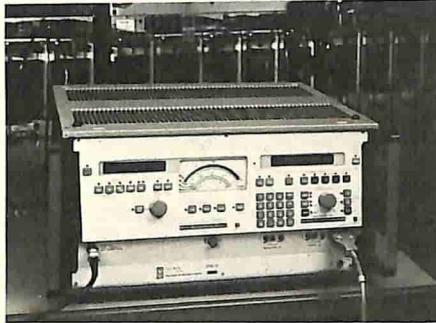
Le frequenze controllate da un quarzo possono essere impostate sulla tastiera passo-passo o con continuità con una precisione di  $1 \times 10^{-7}$ %. Sempre operando sui pulsanti della tastiera si possono memorizzare e richiamare le frequenze fissate e tutta la lista delle misure programmate. Su richiesta può essere estesa la capacità di memoria.
