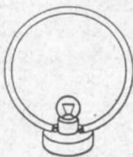
Fig. 55 - Indicatore di risonanza (lampada di prova).
