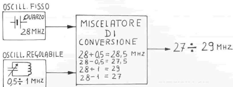
Fig. 15-6 Tipico schema a blocchi di un oscillatore a conversione di frequenza.
