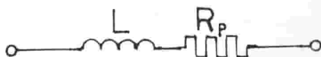
Fig. 6-2 Induttanza ( L ) posta in serie ad una resistenza pura R_p , (resistenza parassita).
