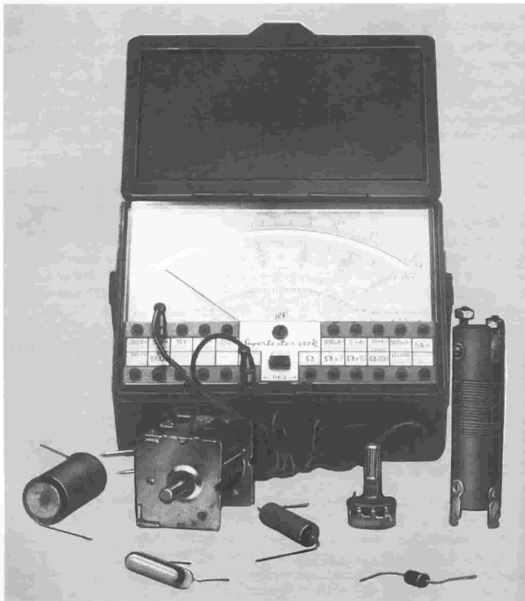
La componentistica passiva; da sinistra a destra vediamo nell'ordine: condensatore ceramico; condensatore elettrolitico; condensatore variabile, condensatore a carta; resistenza variabile (potenziometro); induttanza (bobina); resistenza fissa; al centro il tester (multimetro) per misurare i principali parametri elettrici.
